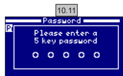
10.11 Пароль: позволяет защитить доступ к меню пользователя паролем. Чтобы указать свой пароль, введите комбинацию из 5 клавиш. Система их сохранит. Если вы забудете пароль, существует «главный пароль». Свяжитесь с установщиком/поставщиком.
